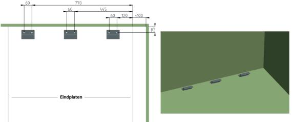
Figuur 13: Opstelling: Plaatsen bevestigingsbeugels bij montage DR-6 op sokkel
