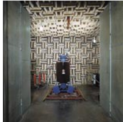
SGB-Regensburg, suchý transformátor v komoře měření hluku
